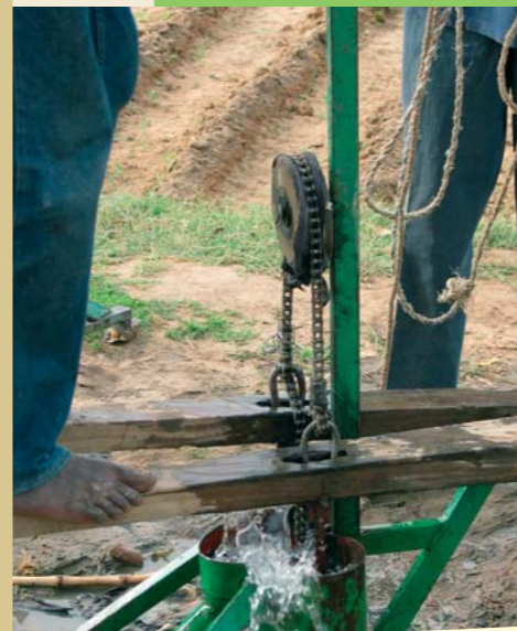
Source SOS SAHEL L'habituelle corde qui relie les pédales de la pompe a été remplacée par une chaîne. Une innovation simple mais efficace au dire des habitants de Soumarana (Niger).
